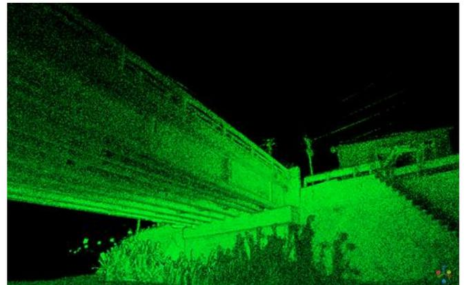
高精度な点群データを活用することにより、災害復旧のための修繕計画において、3D モデルによる修繕コストの早期算出や、構造の安全性を向上することが可能になります。
