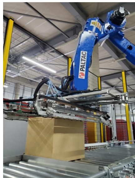
PALTACの物流センターで稼働するロボットハンドを活用した新型自動開梱装置
