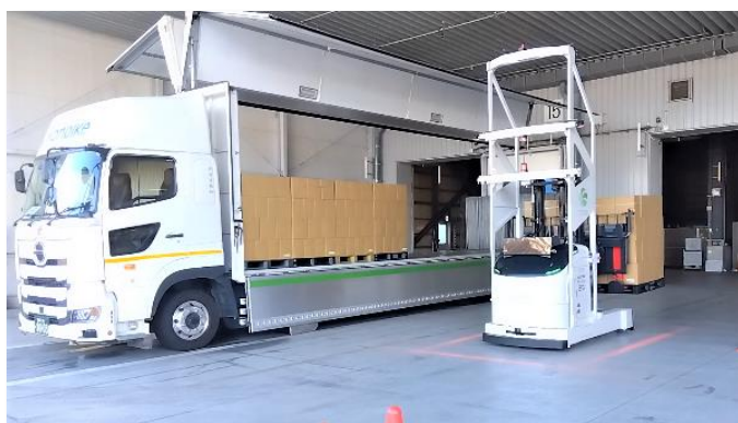
■ AGF が倉庫の荷物をトラックへ搬送
