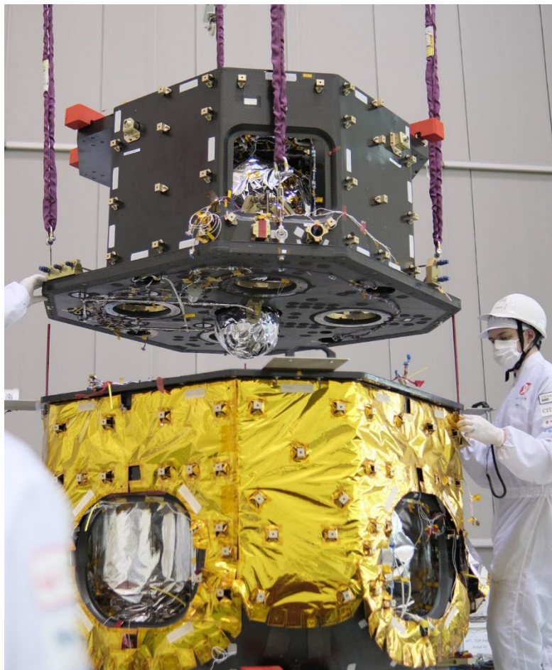
月着陸船の上部と下部を組み合わせるハッティング工程の写真。下部は主に推進システムのコンポーネント(タンク、スラスターなど)を運び、上部は計器、ペイロードなどが含まれる計画
