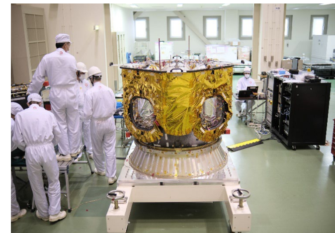
月着陸船の上部と下部を組み合わせるハッティング工程の写真。下部は主に推進システムのコンポーネント(タンク、スラスターなど)を運び、上部は計器、ペイロードなどが含まれる計画
