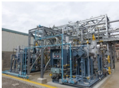
② CO 2 からメタノールを高効率に製造するパイロット設備
